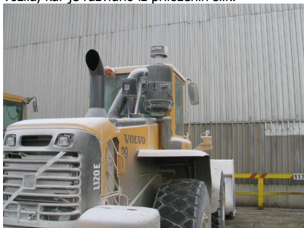
Napačna postavitev filtra.
