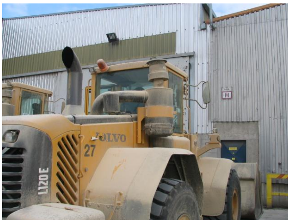
Pravilna postavitev filtra – TAKO NAJ BO POSTAVLJEN
