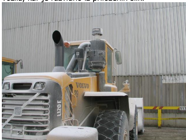
Napačna postavitev filtra.
