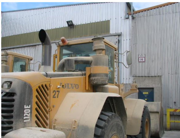
Pravilna postavitev filtra – TAKO NAJ BO POSTAVLJEN
